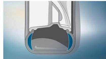
■ **Dekktrykkindikatoren** bruker sensorer som mäter lufttrykk og -temperatur, og varsler føreren når trykket i et dekk faller.
