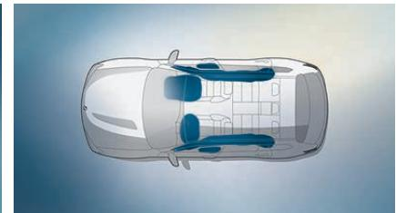
■ **Kollisjonsputene foran** inngår i sikkerhetssystemet til BMW og er perfekt tilpasset de øvrige komponentene. Personene i forsetene beskyttes av frontkollisjonsputer, side- og hodekollisjonsputer.
