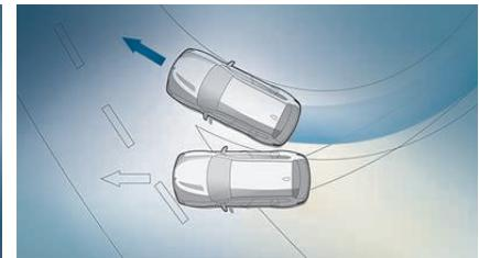
■ **Dynamisk stabilitetskontroll (DSC)** registerer kontinuerlig bilens kjørertilstand og optimerer retningsstabilitet og veigrep ved hjelp av inngrep i motor- og bremsestyringen. Det gjør det lettere å kontrollere bilen under vanskelige kjøreforhold og øker den aktive kjøresikkerheten.
