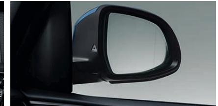
**Lane Change Warning** er et radarbasert system som registrerer om det er kjørerøy i dødvinkelen når du setter på blinklyset for å skifte kjørefelt, hvis bilen har nådd hastigheten som kreves for at systemet skal aktiveres. Funksjonen registrerer også om et kjørerøy nærmer seg raskt i forbikjøringsfeltet. Du varsles ved hjelp av vibrasjoner i rattet og et blinkende varselsymbol i sidespeilet.
