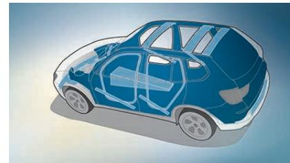
■ **Kupeen** har en funksjonelt konstruert struktur med spesielle bærebjelker og knutepunkter. Den utmerker seg også med målrettet bruk av svært sterke materialer som gir optimal passiv sikkerhet i tilfelle en kollisjon forfra, fra siden eller bakfra.
