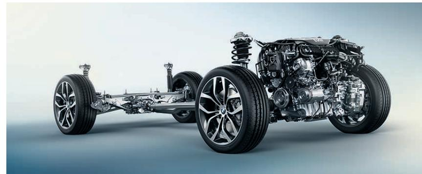
**Performance Control** er standard og fordeler driv- og bremsekraften på hvert enkelt hjul i svinger. I en sving tilbakelegger det ytre hjulet lengre vei enn det indre. Performance Control griper inn ved å regulere motoreffekten og bremse målrettet. Dette innebærer at de ytre hjulene tilføres mer kraft og de indre mindre, slik at alle hjulene har maksimalt veigrep. Bilen dreier nærmest inn i svingen, og det gir økt kjøresikkerhet og bedre kjøredynamikk.
