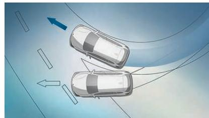
■ **Dynamisk stabilitetskонтroll (DSC)** registrerer kontinuerlig bilens kjøretilstand og optimerer retningsstabilitet og veigrep.
