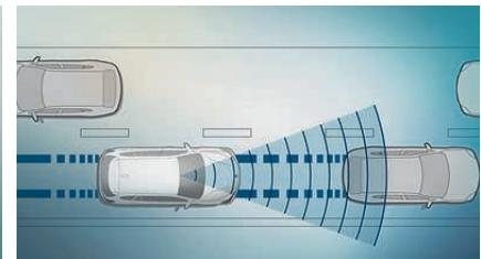
■ **Sammenstøtvarsling med City-bremsefunksjon<sup>2</sup>** varsler deg om fare for kollisjon og kan bremse bilen i en nødssituasjon.
