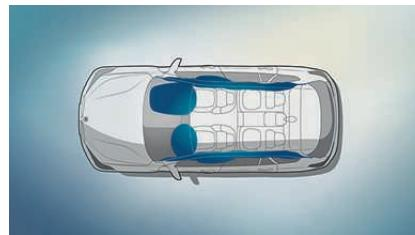
■ **Kollisjonsputene foran** inngår i sikkerhetssystemet i en BMW og er perfekt tilpasset de øvrige komponentene. Personene i forsetene beskyttes av frontkollisjonsputer, hodekollisjonsputer som dekker hele sidevindusflaten, og sidekollisjonsputer i forseteryggen.
