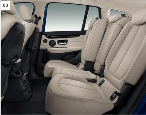
[ 03 ] Baksetebenken har tre fullverdige sitteplasser som kan forskyves i lengderetningen i forholdet 60:40. Bakseteryggen kan deles og legges ned i forholdet 40:20:40, og i tillegg kan vinkelen justeres. Dette gjør det mulig å utnytte lasteplassen maksimalt. (Setetrekk i oysterfarget perforert daktotaskinn med grå kontur, ekstraustyr, er avbildet.)
