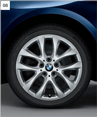
[ 07 ] Takelysene som er integrert i støtfangeren foran, sørger for økt sikkerhet når det er dårlig sikt. [ 08 ] 17" lettmetallfelger V-eke 479 med nødkjøringsegenskaper. 7,5J x 17 med dekkdimensjon 205/55 R17 (standard på 220i og 220d xDrive).
